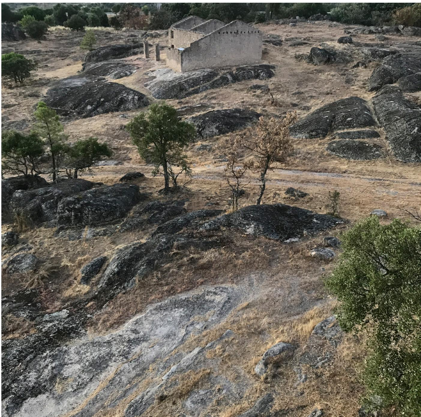
2. - Les murs reposent directement sur les rochers, faits du même granit. Il n'y a ni terrassement ni creusement de fondations, comme cela se pratiquait traditionnellement dans l'Alentejo. La construction n'est qu'une addition, sans aucune soustraction. De même, les vestiges trouvés sur le terrain sont laissés intacts. Ils resteront comme les ruines néolithiques que l'on trouve dans la région.
